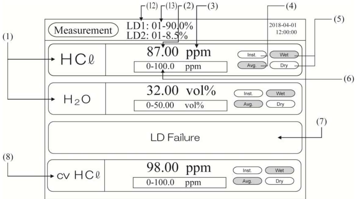
e.g.) Display of HCl + H<sub>2</sub>O meter
