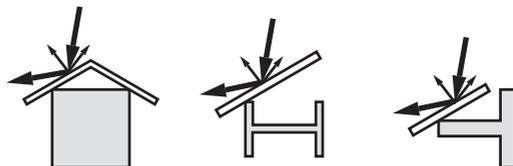
Fig. 20: Recouvrir les obstacles lisses par des déflecteurs
