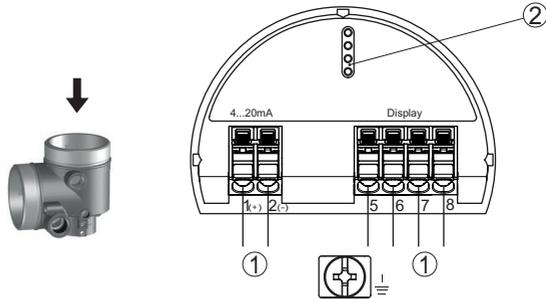
Fig. 28: Compartiment électronique - boîtier à deux chambres
