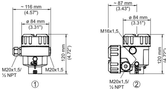
Fig. 5: Variantes de boîtier en protection IP66/IP68 (0,2 bar), (avec un module de réglage et d'affichage intégré, la hauteur du boîtier augmente de 18 mm/0.71 in)
