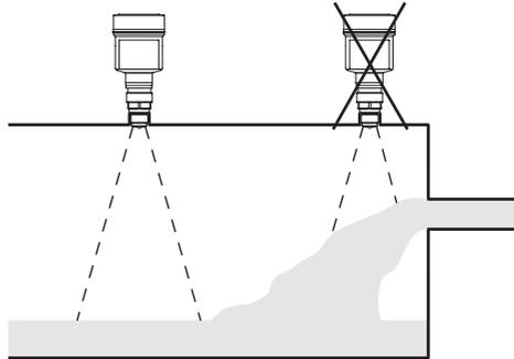
Fig. 16: Montage du capteur radar en présence d'un flux de produit
