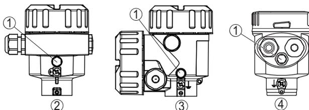
Fig. 9: Position du filtre en fonction du boîtier
