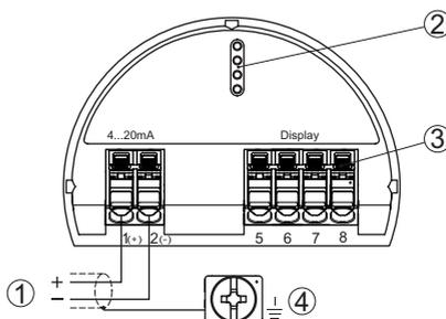
Fig. 27: Compartiment électronique et de raccordement - boîtier à chambre unique
