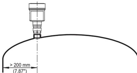
Fig. 13: Montage du capteur radar dans une cuve à toit bombé
