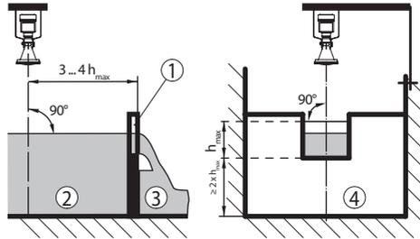
Fig. 24: Mesure du débit avec déversoir rectangulaire:  $h_{max}$  = remplissage max. du déversoir rectangulaire
