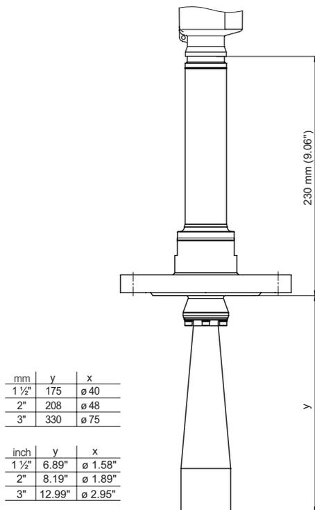
Fig. 8: NivoRadar 8500, bride avec antenne cône version 450 °C
