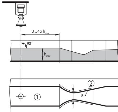
Fig. 25: Mesure du débit avec canal Venturi Khafagi :  $h_{max}$  = remplissage max. du canal ; B = resserrement max. du canal
