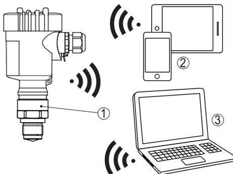
Fig. 2: Connexion sans fil aux unités de réglage standard avec Bluetooth intégré LE
