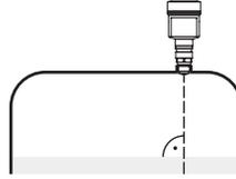
Fig. 21: Orientation du capteur dans les liquides
