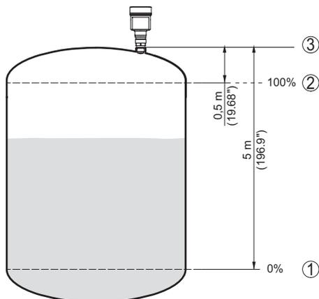
Fig. 34: Exemple de paramétrage du réglage min./max. - Liquides
