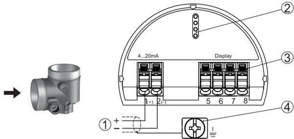
Fig. 29: Compartiment de raccordement - boîtier à deux chambres
