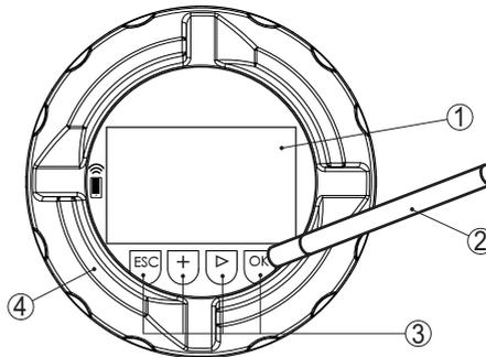
Fig. 33: Éléments de réglage et d'affichage - avec paramétrage par le stylet
