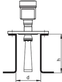
Fig. 18: Montage sur réhausse avec des dimensions de réhausse variables - Antenne-cône
