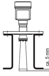
Fig. 17: Montage sur réhausse recommandé - Antenne cône
