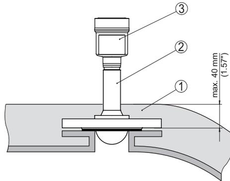
Fig. 19: Montage de l'appareil dans des cuves isolées
