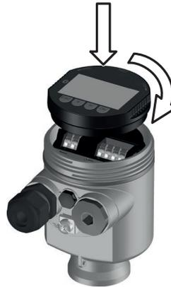
Fig. 30: Montage du module d'affichage et de réglage dans le boîtier à chambre unique se trouvant dans le compartiment de l'électronique
