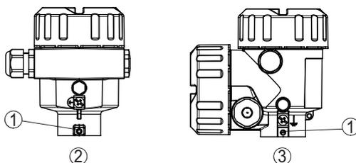
Fig. 10: Position de la vis d'arrêt selon le boîtier
