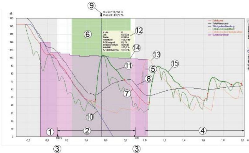
Fig. 42: Zones dans la fenêtre de courbe écho avec option de représentation "Plage de représentation étendue"
