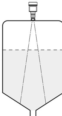
Fig. 14: Montage du capteur radar dans des cuves à fond conique
