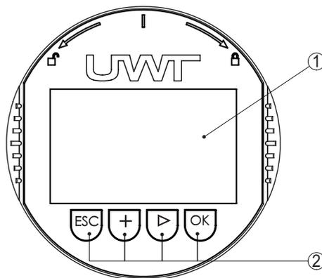
Fig. 32: Éléments de réglage et d'affichage
