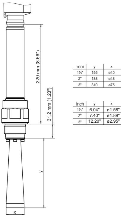
Fig. 7: NivoRadar 8500, filetage avec antenne cône version 450 °C
