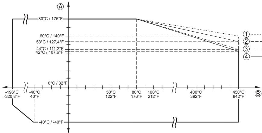
Fig. 4: Derating température ambiante, bantenne cône jusqu'à +450 °C (+842 °F)
