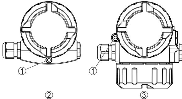
Fig. 11: Position de la vis de sécurité selon le boîtier
