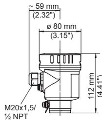
Fig. 6: Variantes de boîtier en protection IP66/IP68 (0,2 bar), (avec un module de réglage et d'affichage intégré, la hauteur du boîtier augmente de 18 mm/0.71 in)
