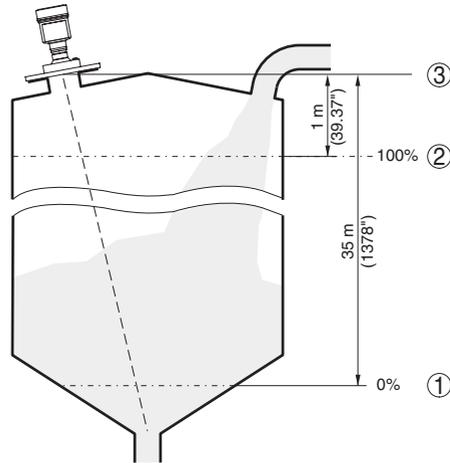
Fig. 35: Exemple de paramétrage du réglage min./max. - Solides en vrac
